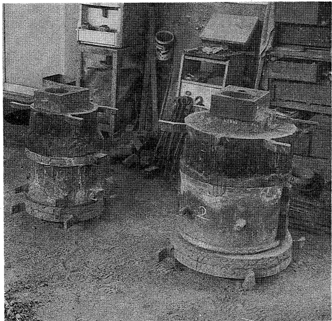
図25 半鐘の鑄造例 (昭和57年5月京都太秦 岩澤の梵鐘株式会社) 本例は湯入れをすませ た後で掛金(縮金)をは ずしてある。
