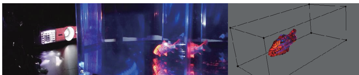
図1：水中生物の実時間3次元形状計測と自由視点映像生成。左：撮影環境。右：計測された3次元形状
