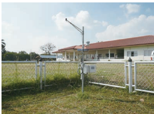
図-5 タイ王立灌漑局ラマ6世ダム事務所に設置した気象観測装置
