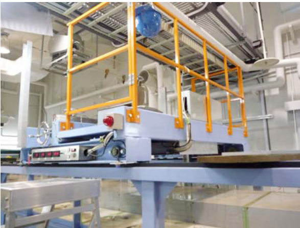
写真-4 自走式大型計測台車： 乗用タイプで水路の上方から流れをラングレンジ追跡が可能、最高速50cm/s。x、y、zの3次元トラバース装置付帯。
