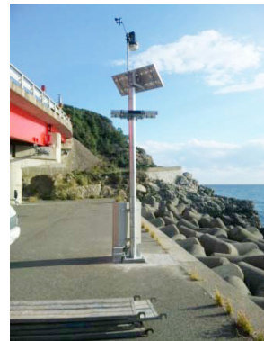
図-6 気象観測および付着塩分現地計測（和歌山県すさみ町）
