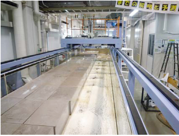
写真-3 大型開水路シミュレータ： 150cmの広幅可変勾配型循環水路。3つのインバータモータをコンピュータ制御して最大120リットル/sの流量を発生可能。任意形状の洪水流を再現できる。
