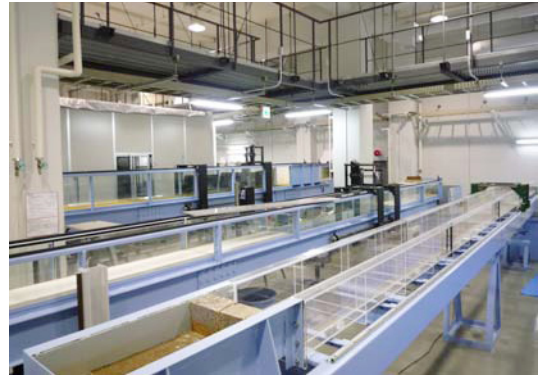
写真-1 空調完備の乱流水理実験室：貯水槽・ポンプ・電装類が設置された地下ピット、水路や計測装置が配置された1階フロアおよび水理観察用のキャットウォークから構成される世界でも稀な3層立体構造の水理実験室である。可変勾配型循環水路5台、マルチフェイズ風洞水槽1台、レーザードップラー流速計、高速度カメラその他関連計測機器を多数保有。
