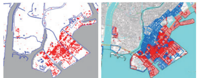
図-2 (左図) レーダー衛星による浦安市の液状化被害の検出結果 (赤)、(右図) 国土交通省関東地方整備局と地盤工学会による現地調査データ (赤: 液状化、青: 非液状化)
