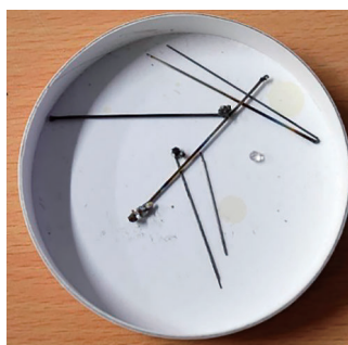
図1. (左) 実験に用いた電子レンジが右上, 中央に分光器がある. (中央) アンテナとして用いたシャープペンの芯と待ち針. シャープペンの芯は両端がやせ細り, 待ち針の両端は高温で溶けて固まりができています. (右) アンテナとして用いるシャープペンの芯や待ち針を高温に耐えられる陶器の皿にのせ, 耐熱コップをかぶせて, プラズマ閉じ込めの容器とする.
