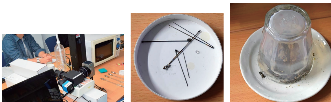
図1. (左) 実験に用いた電子レンジが右上, 中央に分光器がある. (中央) アンテナとして用いたシャープペンの芯と待ち針. シャープペンの芯は両端がやせ細り, 待ち針の両端は高温で溶けて固まりができています. (右) アンテナとして用いるシャープペンの芯や待ち針を高温に耐えられる陶器の皿にのせ, 耐熱コップをかぶせて, プラズマ閉じ込めの容器とする.
