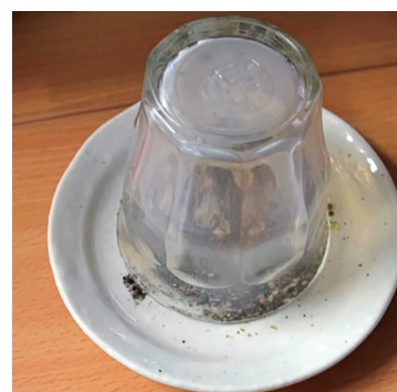
図1. (左) 実験に用いた電子レンジが右上, 中央に分光器がある. (中央) アンテナとして用いたシャープペンの芯と待ち針. シャープペンの芯は両端がやせ細り, 待ち針の両端は高温で溶けて固まりができています. (右) アンテナとして用いるシャープペンの芯や待ち針を高温に耐えられる陶器の皿にのせ, 耐熱コップをかぶせて, プラズマ閉じ込めの容器とする.
