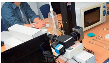
図1. (左) 実験に用いた電子レンジが右上, 中央に分光器がある. (中央) アンテナとして用いたシャープペンの芯と待ち針. シャープペンの芯は両端がやせ細り, 待ち針の両端は高温で溶けて固まりができています. (右) アンテナとして用いるシャープペンの芯や待ち針を高温に耐えられる陶器の皿にのせ, 耐熱コップをかぶせて, プラズマ閉じ込めの容器とする.
