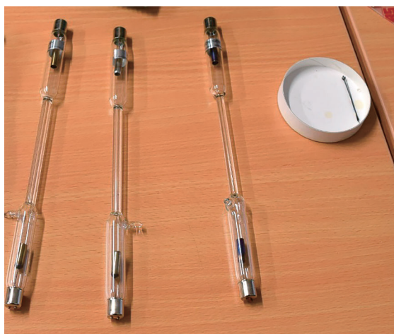
図1. (左) 実験に用いたガス管。大まかの大きさを示すため右側の白い容器に待ち針を入れた。(右) ガス管が放電する様子。ガス管手前に分光器を設置している。
