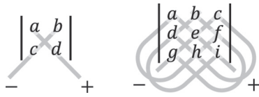
Fig. 5. The rule of Sarrus to calculate the determinants of 2×2 and 3×3 matrices. 2×2 および 3×3 の行列の行列式の計算法, 右下がりの線上の成分の積を足し, 左下がりの線上の成分の積を引く.
