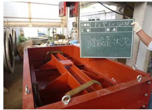
写真-4.4 載荷板設置
