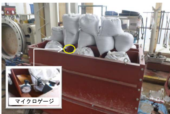
写真-4.14 土嚢袋による上乗荷重①
