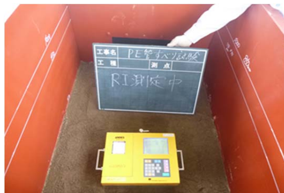
写真-4.7 締固度の測定
