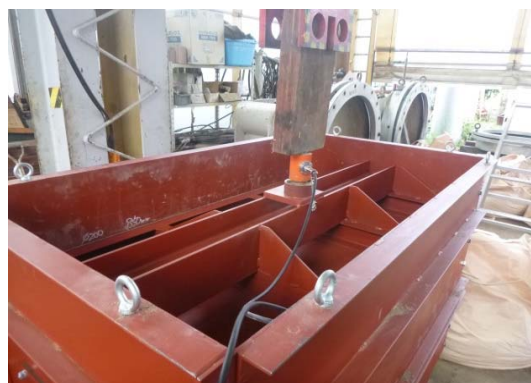
写真-4.15 油圧ジャッキによる上乗荷重②
