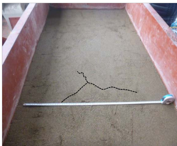
写真-4.16 上面に生じた亀裂 (呼び径 200 給水分岐)
