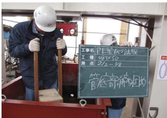
写真-4.6 木ダコを用いた締固め
