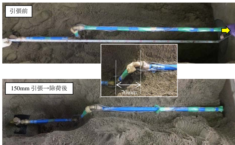
写真-7.8 クランク配管の実験結果 (上段：実験前，下段：実験後)
