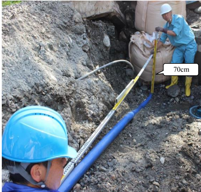
写真-1.13 鉛直方向変位 70cm
