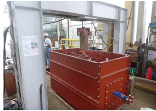
写真-4.2 上載荷重の載荷状況
