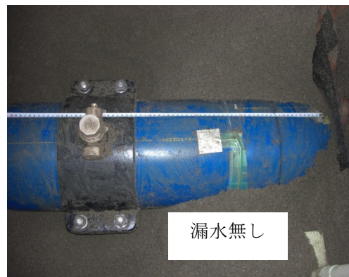
写真-6.8 100mm 変位後（呼び径 200）
