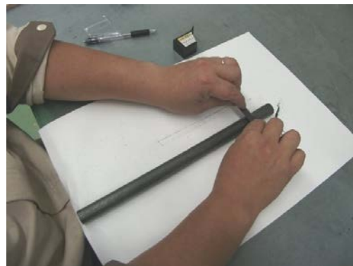
写真 3.4 X線回折用試料採取状況
