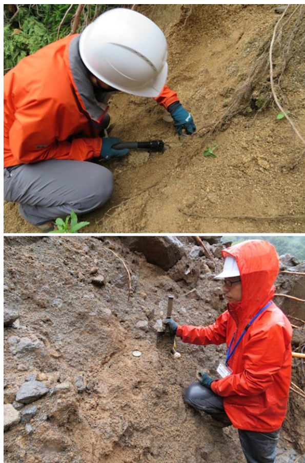
図4-3 水理特性試験のため土層採取を行っている様子 (上図：赤谷川流域 乙石川の近傍の小規模崩壊、 下図：花月川流域 小野地区の大規模崩壊)
