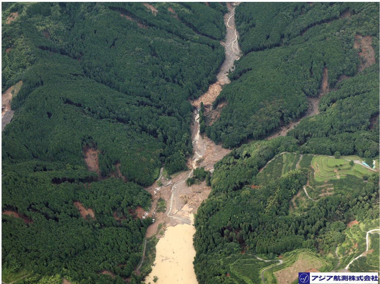
図-91 妙見川の状況（7月9日）。土砂に混じって多量の流木が堆積している。（撮影：アジア航測）
