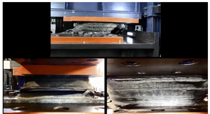
図1 ゴム支承の破断時写真
