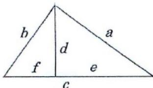
$b$  の交)が直角なる三角形において、頂点から下辺  $c$  に垂線  $d$  を降し、下辺を  $e$  と  $f$  に分ける。 $\triangle cba$  と  $\triangle ade$  は相似だから  $a : c = e : a$ , よって  $a^2 = ce$ . また、 $\triangle cba$  と  $\triangle bfd$  は相似だから、 $b : c = f : b$ ,  $b^2 = cf$ . そこで平方の和を作れば、
