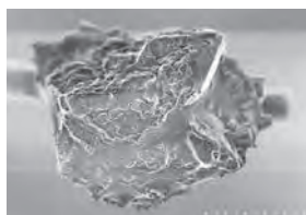
↑イトカワ粒子の走査型電子顕微鏡写真。注意深く観察すると、宇宙風化の痕跡も観察できることがわかった。物質の微小な組織や構造を観察できる電子顕微鏡。音の振動でさえ、試料が吹き飛ばす原因となるため、壁には吸音材が貼られている
