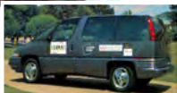
自動運転車 NAVLAB1(左)、NAVLAB5(右) 1986年開発の最初の自動運転車NAVLAB1。NAVLAB5は「No Hands Across America(手をはなしてアメリカ横断)」とよばれた自動運転デモに1995年に成功した
