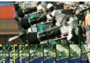
Eye Visionシステム 2001年のスーパーボウルでつかわれた。映画「マトリックス」のようなリプレイシステム
