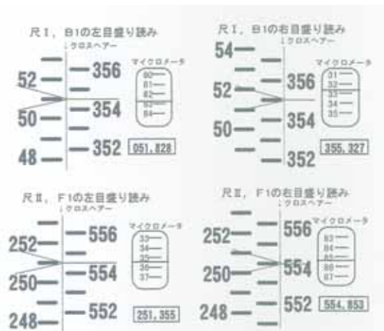
図 6 . 標尺の読みとマイクロメータの読み
