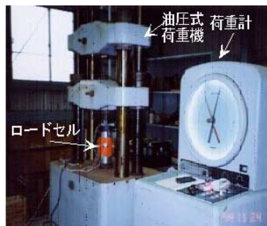
図1 . 万能試験機システム
