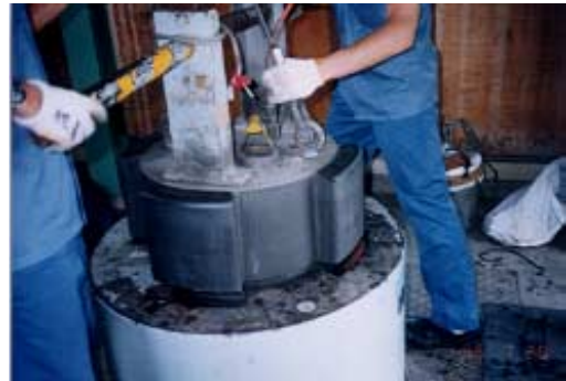
図 9 . 高圧実験装置
