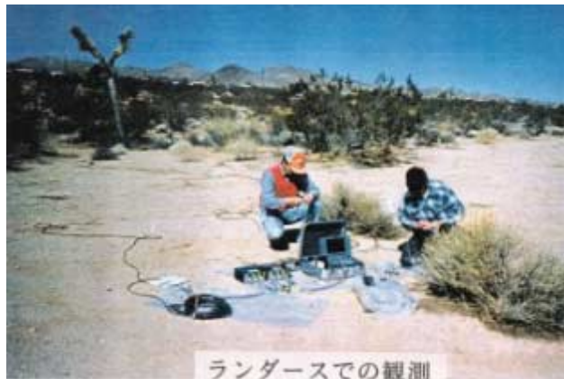
写真16 地盤特性調査の準備作業
