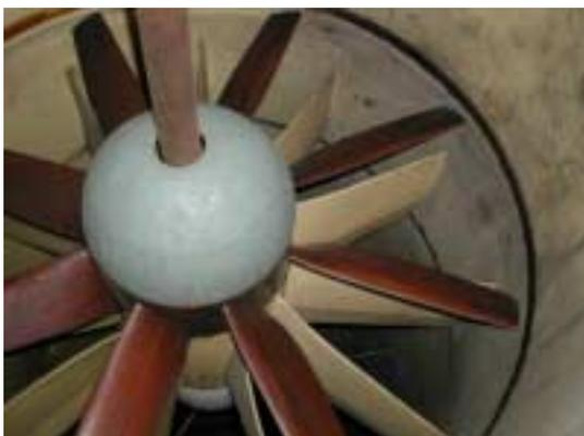
写真3 回流型風洞 木製ファン
