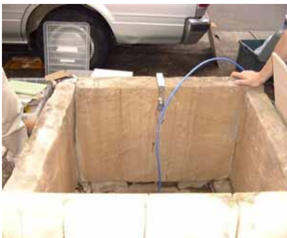
写真8 ケーブル固定
