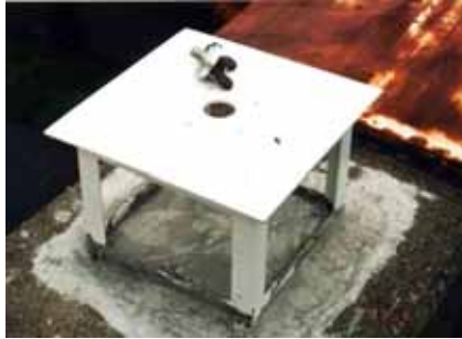
写真 10 金属製アンテナ架台 (上部のネジは整準台固定用)
