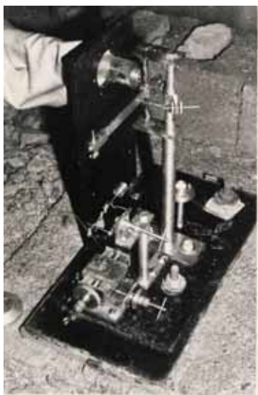
写真 1 光学式伸縮計増幅部
