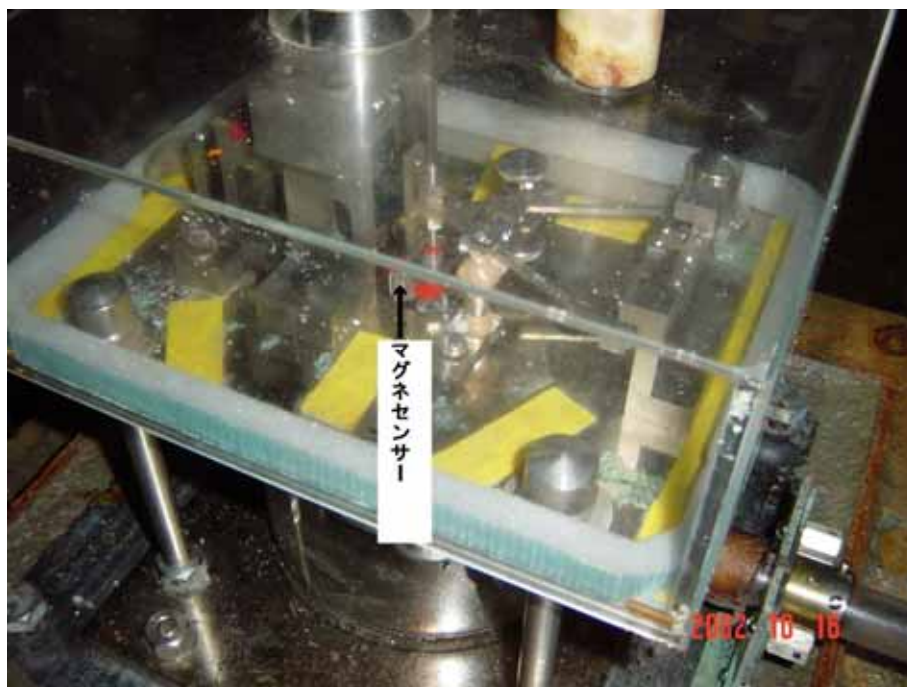
写真 4 電子式水管傾斜計増幅部
