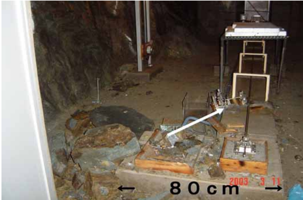
写真5 落石及び破壊された観測計器
