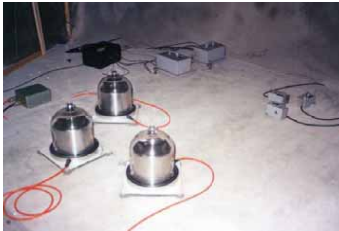
写真 8 STS 地震計 (ガラス容器で気圧が低い)
