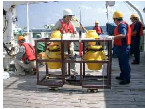
写真6 UTHD(長周期海底電位磁力形)
