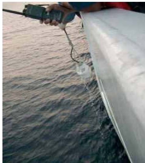
写真8 音波発進装置
