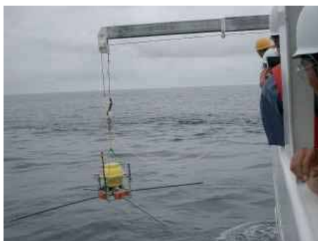
写真 3 OBE : KPC-E (短周期海底電位差計)
