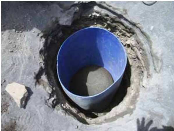
写真5 地震計台と保護管
