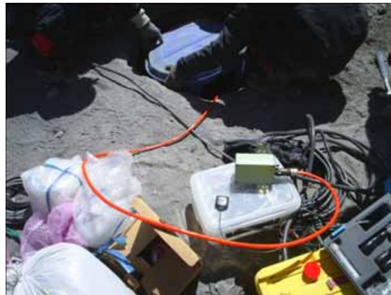
写真8 地震計コントローラ
