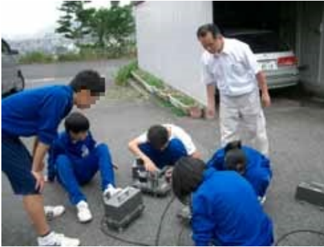
写真4 地震計の設置
