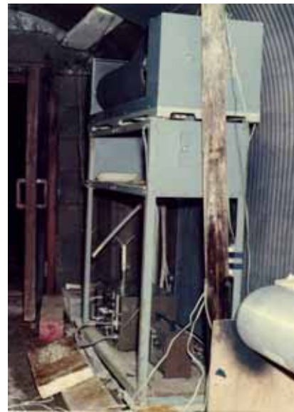
写真3 煤かけ記録装置。 (2mm/sから4mm/sに変更して記録を始めた。)
