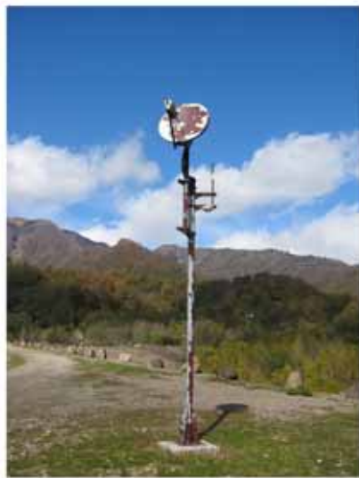
写真7 大白川観測点のデータ送信衛星アンテナ。豪雪地帯のため、アンテナの位置は地上 4,5m
