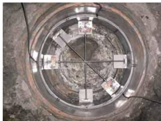
写真 12：ひずみ計設置状況
