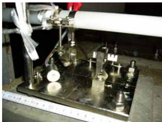
写真3：ひずみ計センサー部
