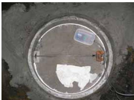
写真10：設置したひずみ計
