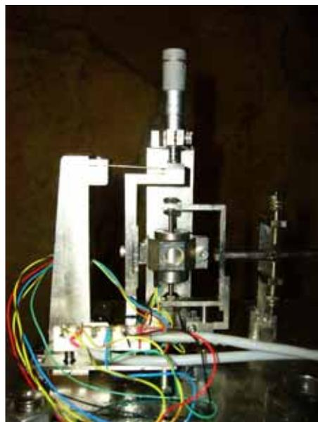
写真2：水管傾斜計センサー部
