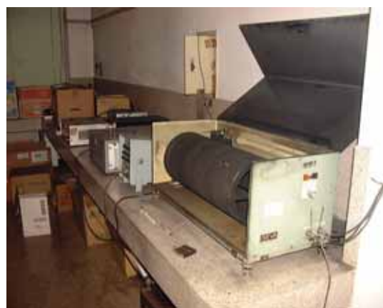
写真 3 記録ドラム(稼働中)
