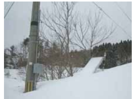
写真 16 約 1m の積雪で埋まった観測装置（大大特）
