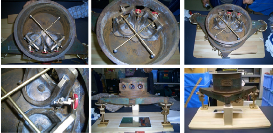
写真8 傾斜計復元全体写真
