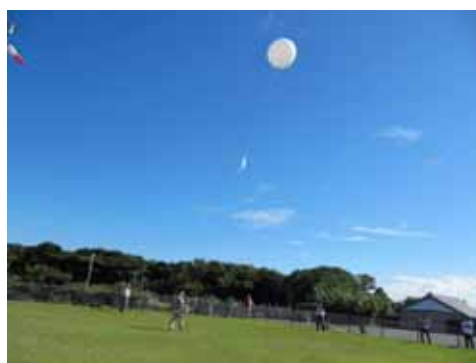
写真 8 : 潮岬測候所でのラジオゾンデ打上げ
