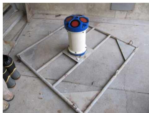
写真 1：ADCP とステンレス製架台
