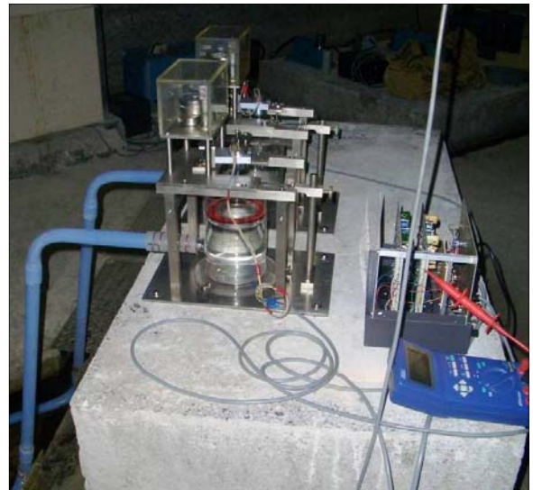
● 伊佐観測室坑道：水管傾斜計 W1A/W3B
