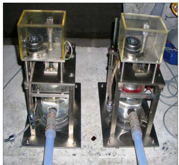
● 伊佐観測室坑道：水管傾斜計 W1A/W3B
