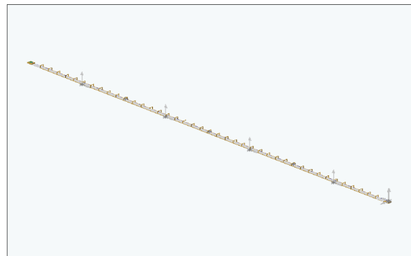
●上5種図：スーパーインバール伸縮計全体図
