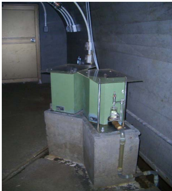
● 宮崎観測所坑内：地殻変動観測計器の設置
