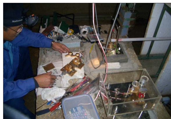
● 阿武山坑道：園田が伸縮計組立設置
