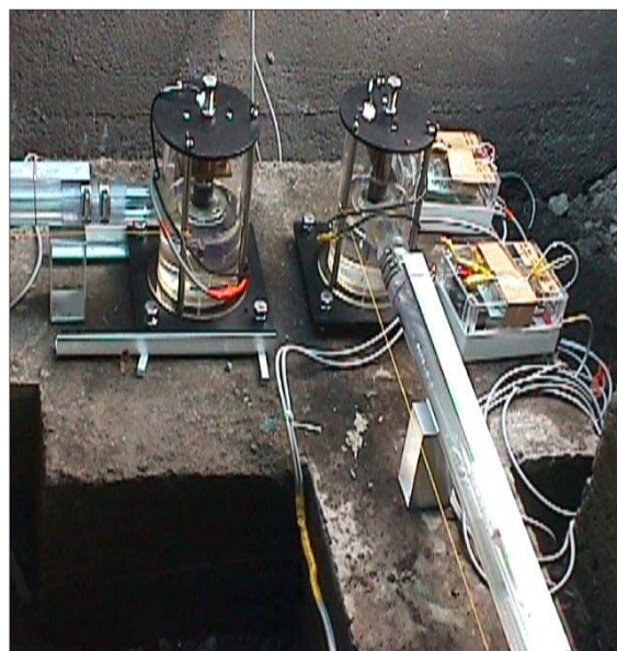
● トレンチ観測壕：2成分センサー部
