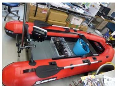
写真 4: 河床地形観測用のゴムボートと測器
