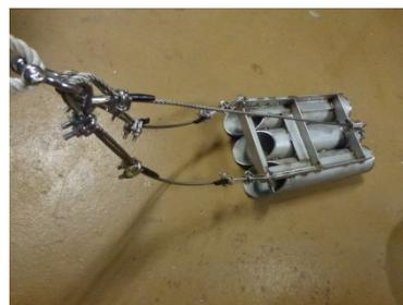
写真 5: ステンレス製採砂器
