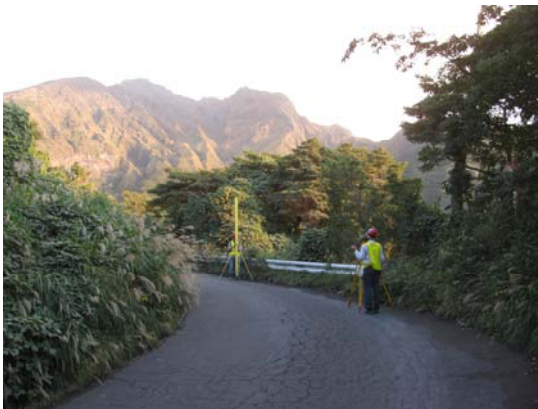
図1. 桜島での水準測量
