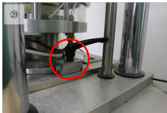
②⑨ 左右のクランプを締め、セルを固定します。
