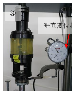
③⑩ ストッパーをひねりながら垂直载荷用アクチュエーターを下げ、アクチュエーターと荷重トルク検出器を三本のボルトでつなぎます。
