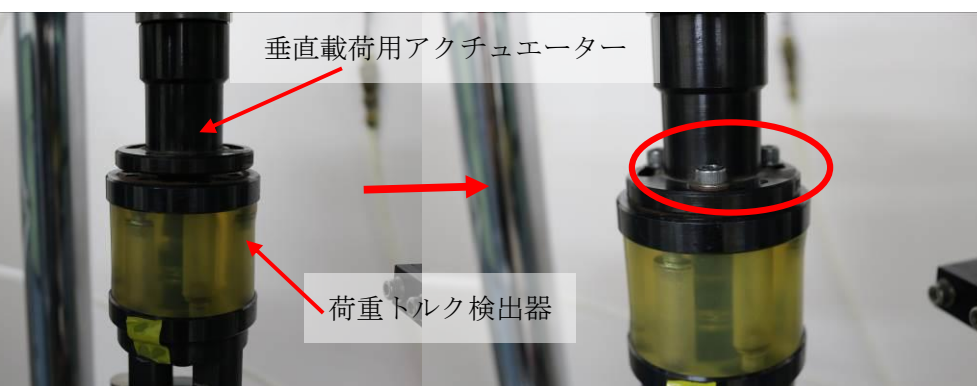
③⑩ ストッパーをひねりながら垂直载荷用アクチュエーターを下げ、アクチュエーターと荷重トルク検出器を三本のボルトでつなぎます。
