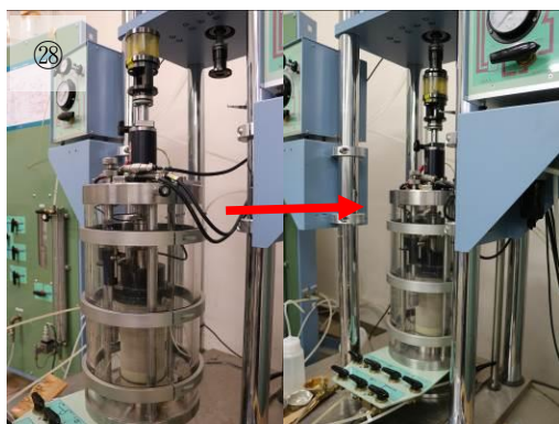
②⑧ エアースライドのバルブを開け、セルを所定の位置まで移動します。
