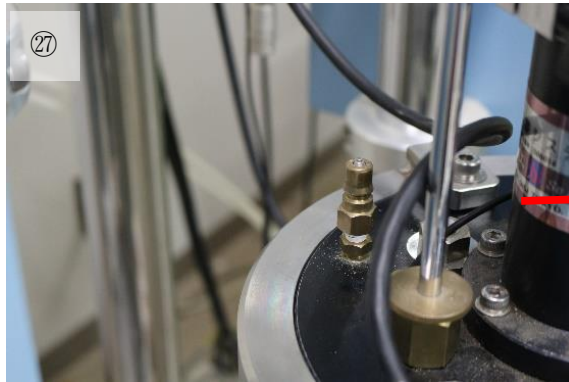
②⑦ 横圧調整系のレギュレーターを 0 にして、脱気水槽への圧供給を止め、セル圧用バルブを外します。セルに取り付けていた空気穴用のカプラを外し、代わりにセル圧用バルブをセルに接続します。
