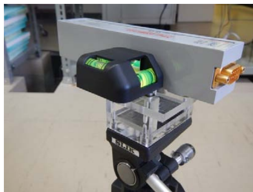
図9 磁力計を取り付けた取り付け治具
