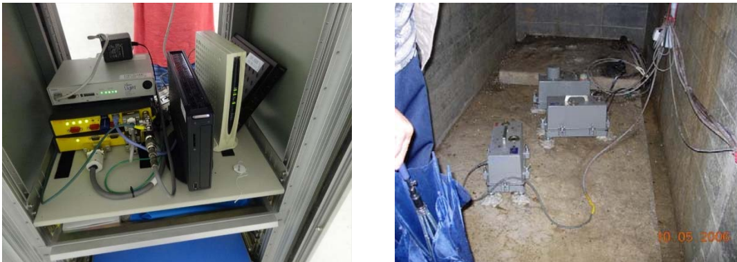
Figure 2 観測システム(左がロガー、右が地震計)
