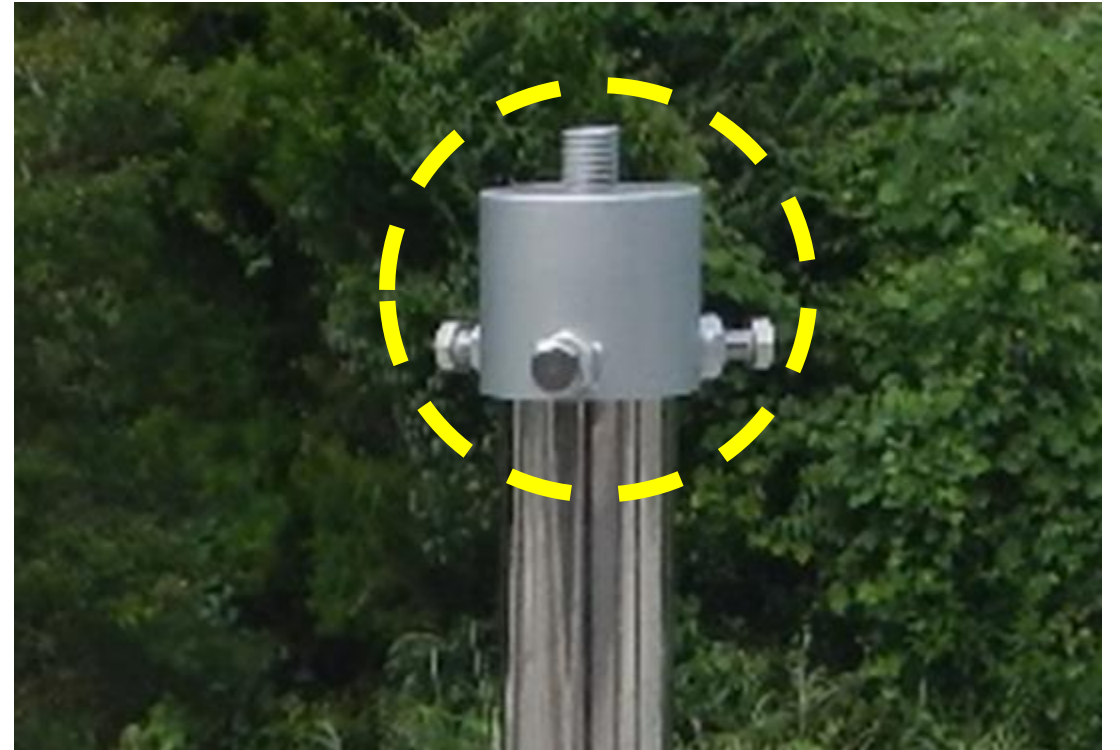
アンテナ取付け治具
