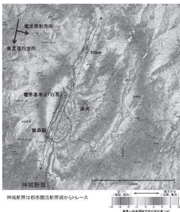
図2 2014年長野県北部の地震に関する干渉SAR画像。既知の活断層と干渉SAR画像の不連続が一致し地表地震断層の位置とも一致した。
