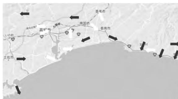
図-7 地上観測ネットワークによる風向観測例。これらのうち、本共同研究費によるものは高知市内の4箇所と南国市の高知大学医学部に設置された5基である。
