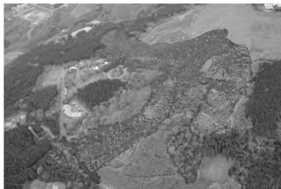
写真 2 高野台地区の流動性の高い地すべり (読売新聞社機より福岡が撮影)
