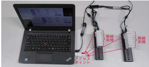
図5 省電力 IoT 用無線システム Wi-SUN の実験例 (F-RIT プロトコルを利用)
