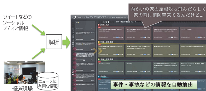
図9 ソーシャルメディアからの事件・事故などの情報をリアルタイムかつ正確に抽出するシステム (ユーザーが抽出結果をチェックし、システムを再学習させる機能も実現)
