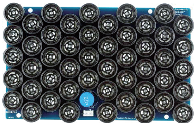
図 1. パラメトリックスピーカーの例 (40kHz, 49 素子, 素子単体の超音波出力約 120 dB) [ https://www.switch-science.com/ ]
