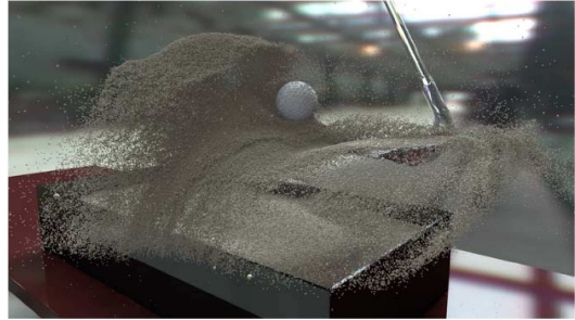
第 5 図 離散要素法による 1,670 万粒子を用いたバンカーショットのシミュレーション
