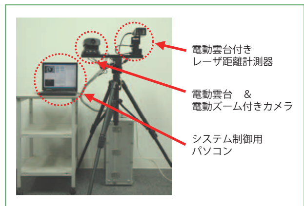
図-8 マーカ位置自動計測システム
