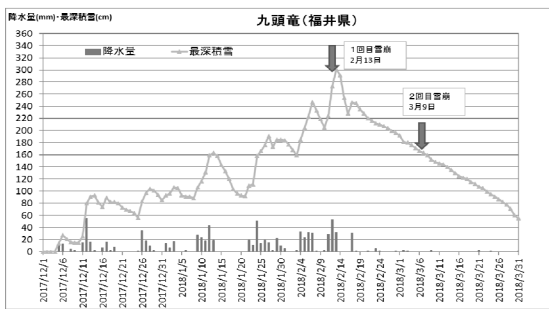
図-17 気象・積雪の変化(九頭竜アメダス観測点)と雪崩発生日
