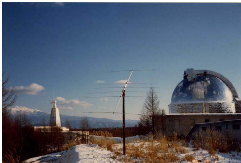
木星電波の多地点観測のために飛騨天文台に設置されたアンテナ
